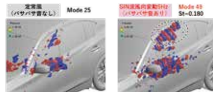
▲図3 モード分解によるバサバサ音の特徴構造抽出
