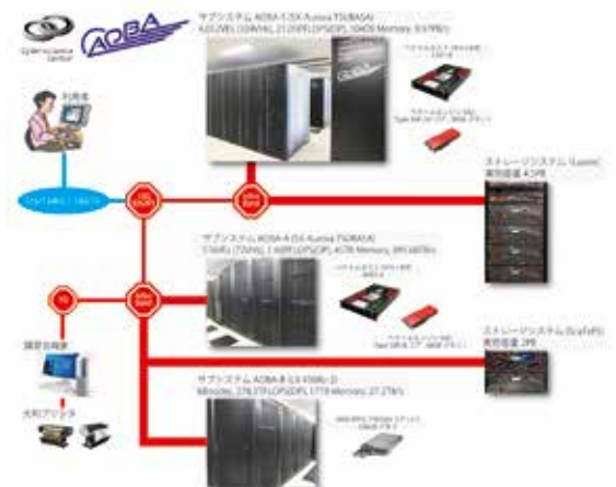
▲図2 東北大学サイバーサイエンスセンターのスーパーコンピュータ、AOBAシステム構成図
