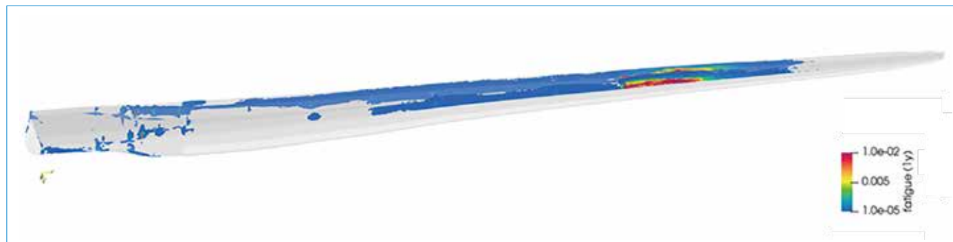
▲図2 NREL5MW風車ブレードの累積疲労損傷解析事例 (TSR=5、入力乱れ10%のケース、最大年間累積疲労損傷=0.858)
