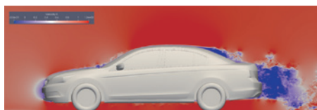
▲図2 FFXによる車両まわり流れ計算における主流方向速度の瞬時分布
