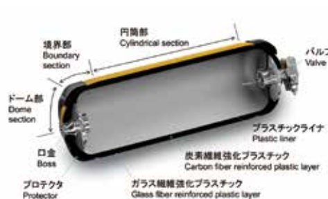
▲図2 高圧水素タンク(タイプ4)の構造
