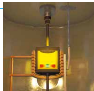
▲結晶成長装置の内部を瞬時に予測してアニメーション化し、プロジェクションマッピング技術により装置に投影。臨場感ある映像により、オペレータは内部の状態を把握しながらパラメータを制御することができる。
