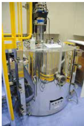
▲宇治原教授らが開発した 結晶成長装置
