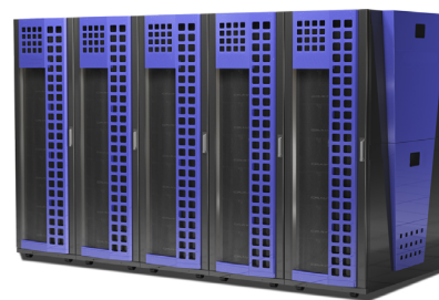
2014年6月にTOP500中450位を獲得した FOCUSスパコン EシステムはXeon Phiを採用し全48ノードで構成されている。
