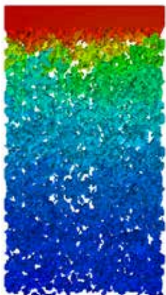
Ni-YSZ 燃料極内酸化物イオン電気化学ポテンシャル分布
