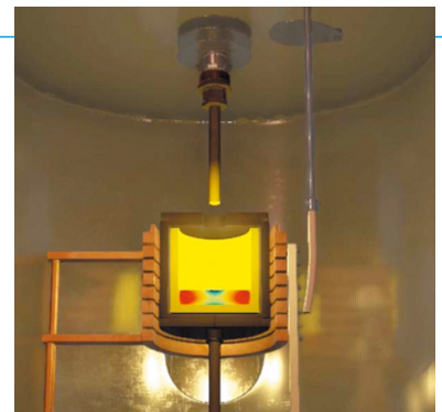
▲結晶成長装置の内部を瞬時に予測してアニメーション化し、プロジェクションマッピング技術により装置に投影。臨場感のある映像により、オペレータは内部の状態を把握しながらパラメータを制御することができる。
