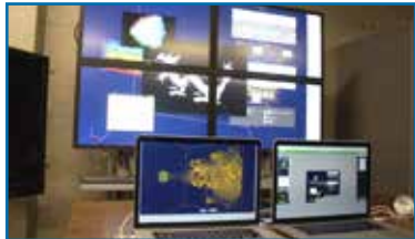
【図3】複数PCによる同一タイルディスプレイの制御
